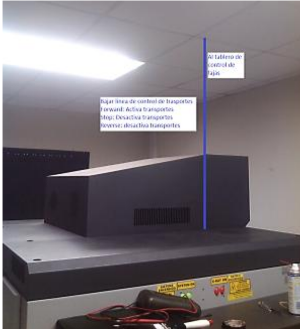
Salida de línea de control de la unidad RX
