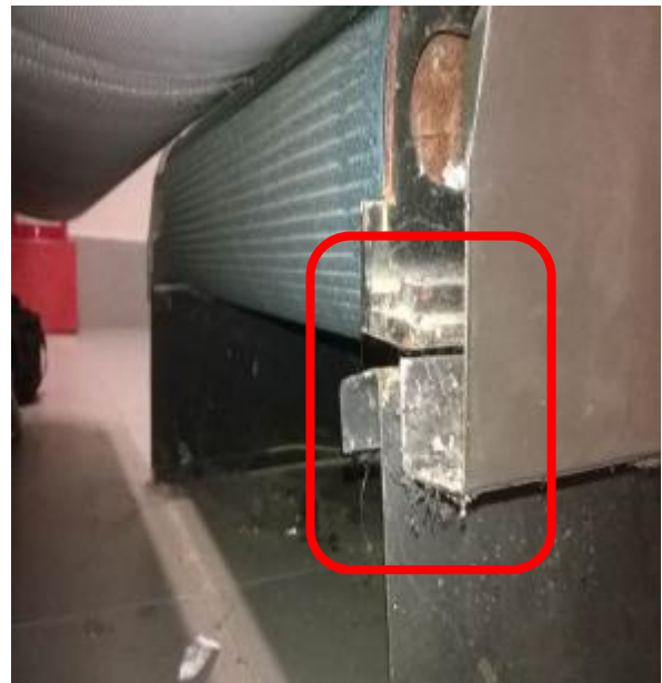
Travesaño con el que se dañó la faja del equipo de inspección
