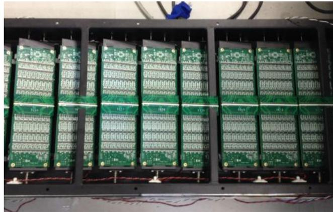
Reemplazo de tarjetas en línea detectora
