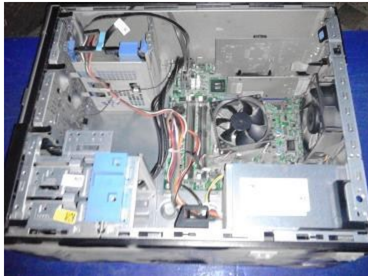
Estado de la computadora (exceso de tierra)
