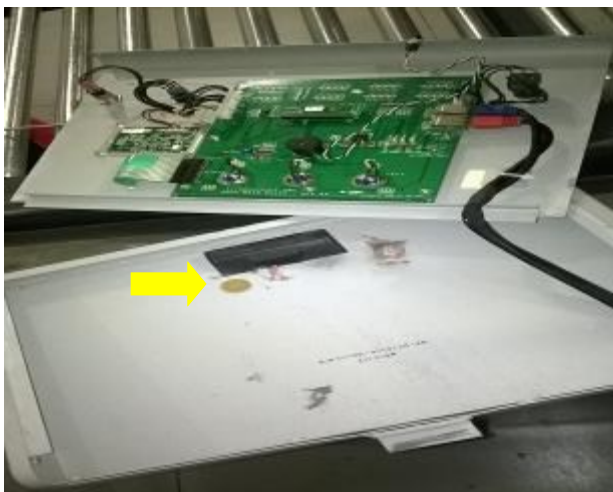
Envoltorios y Moneda, posibles cortocircuitos, se retira y aplica mantenimiento al interior AACP
