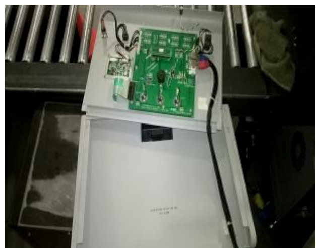
Envoltorios y Moneda, posibles cortocircuitos, se retira y aplica mantenimiento al interior AACP
