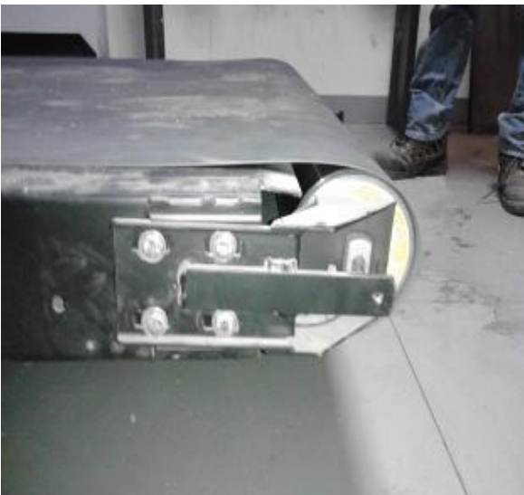
Desmontaje de tornillos motor entrada/salida
