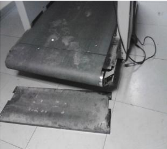
Estado de faja dañada
