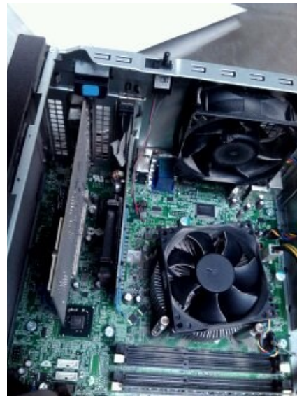
Estado interno de la unidad y de la computadora (exceso de tierra) En la computadora y componentes electrónicos generar calor
